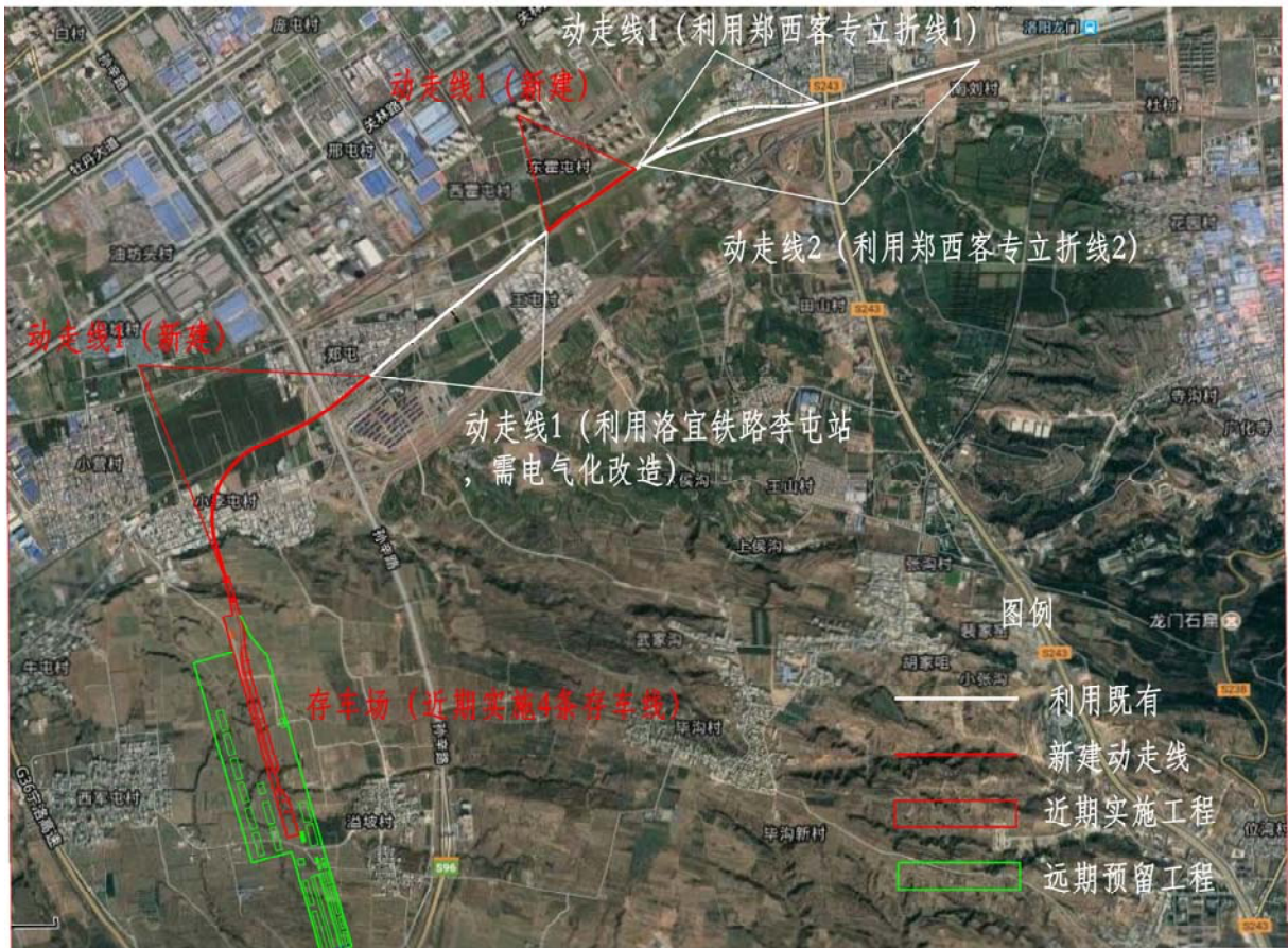
图 1-2 洛阳动车组存车场工程总平面布置示意图
